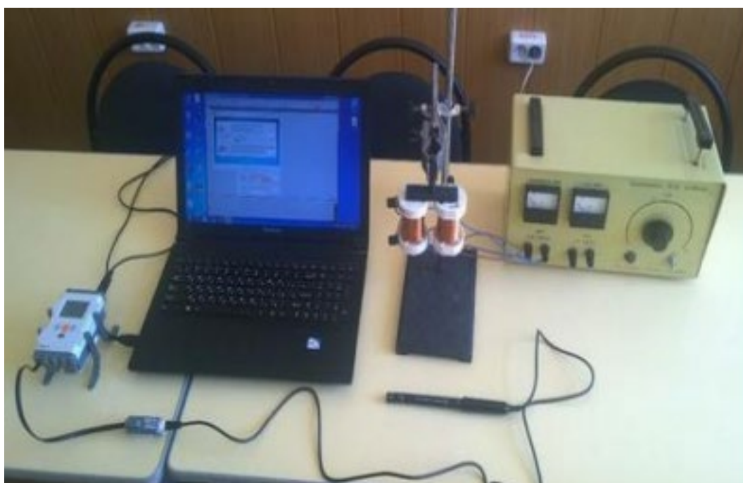
Рис. 14. Лабораторная установка для проведения исследования магнитного поля электромагнита
