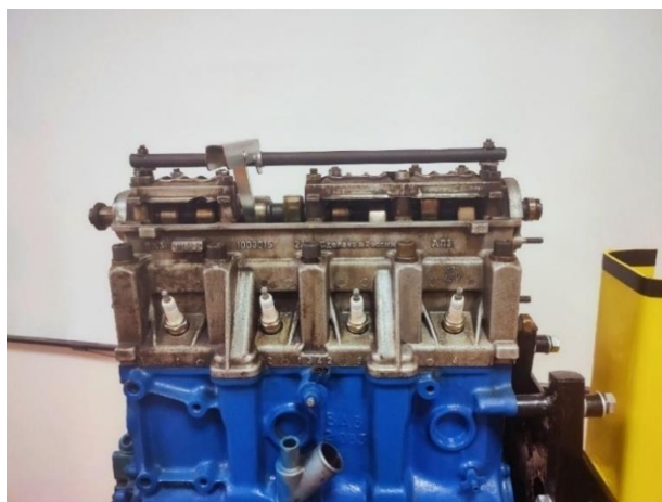
Рис. 2.7 – Приспособления для регулировки клапанов, установленное на стенде «Устройство, проверка и регулировка теплового зазора ГРМ»
