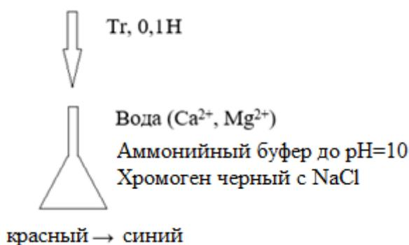
Рисунок 4.1 – Схема титрования колодезной воды трилоном Б для определения общей жесткости
