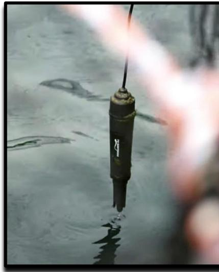
Рисунок 5 - Измерение параметров воды при помощи Plug&Sense! Smart Water
