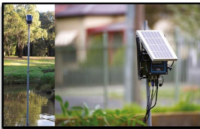
Рисунок 5 - Проактивная система мониторинга качества воды на основе измерительной платформы Waspote Plug & Sense!
