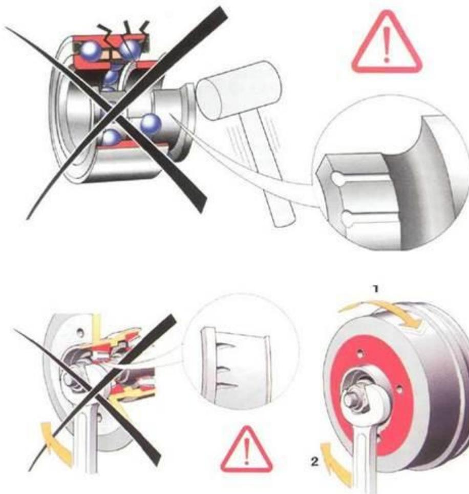
Не забывайте вращать ступицу при затягивании гайки и регулировке зазора в подшипниках. Если этого не сделать, ролики образуют вмятины на дорожках качения. Это приведет к появлению гула и сократит срок службы. Момент затяжки гайки различен для разных моделей автомобилей, поэтому всегда обращайтесь к руководству по эксплуатации автомобиля.
