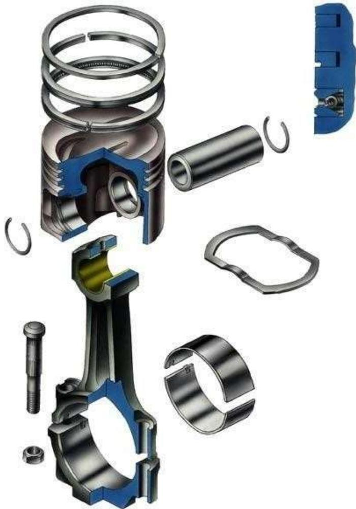
**Ответ.** 1) Компрессионные кольца(10%) ,2) Поршень(10%) ,3) Стопорное кольцо(10%) ,4) Шатун(10%) ,5) Шатунный болт(10%) ,6) Гайка(10%), 7)Маслосъёмное кольцо(10%) ,8)Поршневой палец(10%) ,9)Шатунные вкладыши(10%) ,10)Крышка нижней головки шатуна(10%) .
