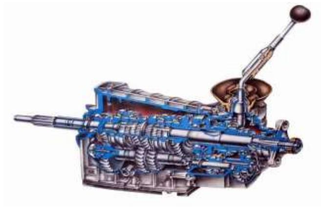
**Ответ. КПП(20%)** предназначено для **длительного(40%)** отключения ДВС от ведущих колёс автомобиля, изменения **скорости(20%)** вращения ведущих колёс, а также обеспечения движения автомобиля **задним(20%)** ходом.
