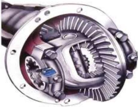
**Ответ.** Редуктор ведущего моста(20%) со встроенным дифференциалом(20%) снижает скорость вращения ведущих колёс автомобиля(20%) и позволяет ведущим колёсам вращаться с разными скоростями(20%) на поворотах(10%) а также при движении по неровной дороге(10%).
