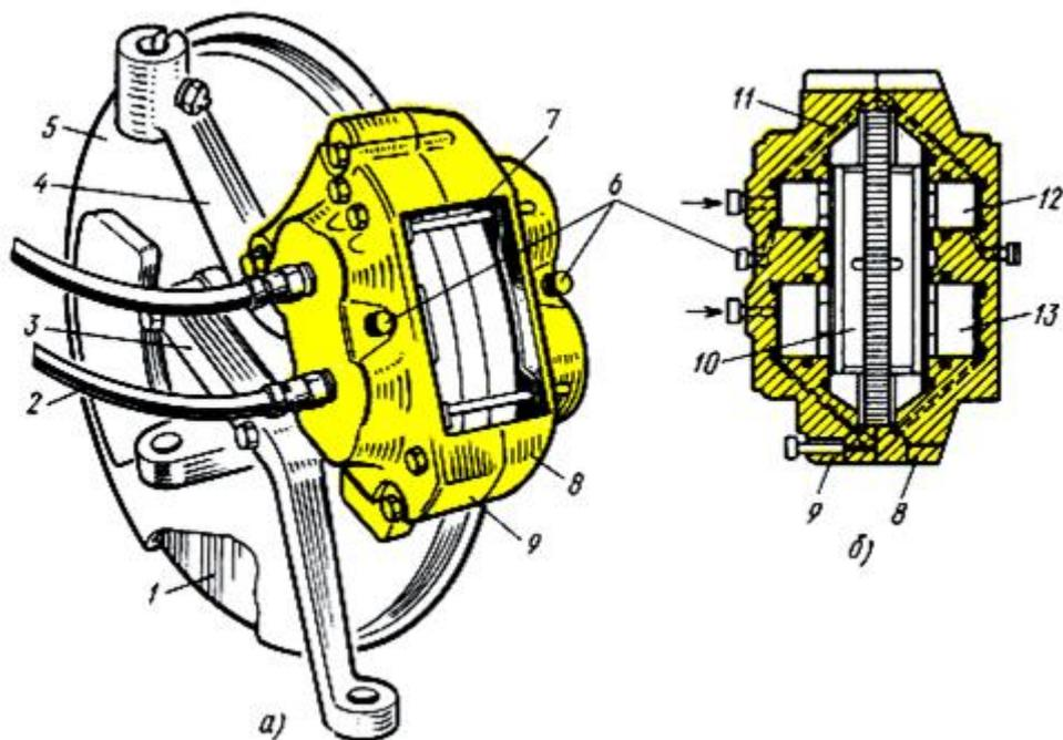
*a* – в сборе, *б* - разрез по оси колесных тормозных цилиндров; 1 – тормозной диск, 2 – шланги, 3 – поворотный рычаг, 4 – стойка передней подвески, 5 – грязезащитный диск, 6 – клапан выпуска воздуха, 7 – шпилька крепления колодок, 8, 9 – половины скобы, 10 – тормозная колодка, 11 – канал подвода жидкости, 12 – поршень малый, 13 – поршень большой
