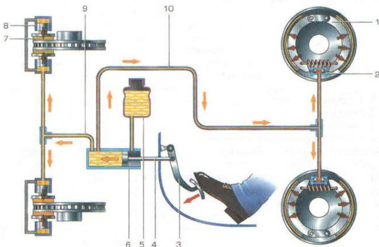
Рис. 2.8 - Тормозная система
