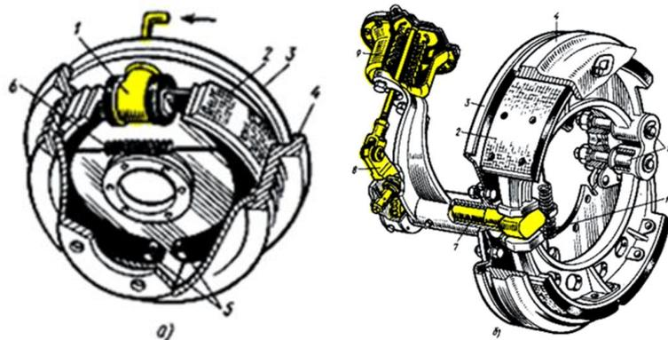
Рис. 2.3 – Колесный барабанный тормозной механизм
