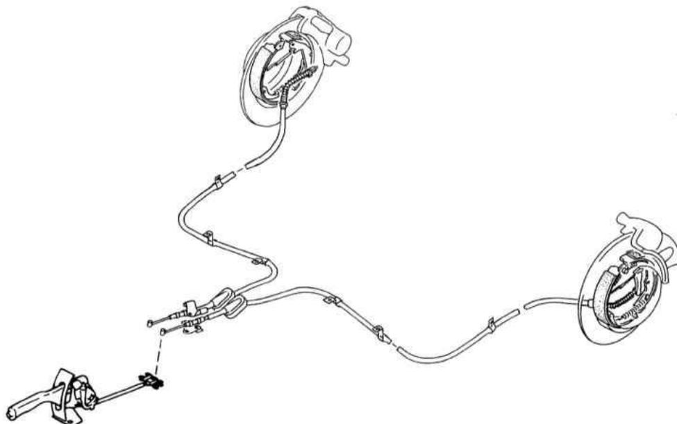
Рис. 2.7 – Схема стояночного тормоза
