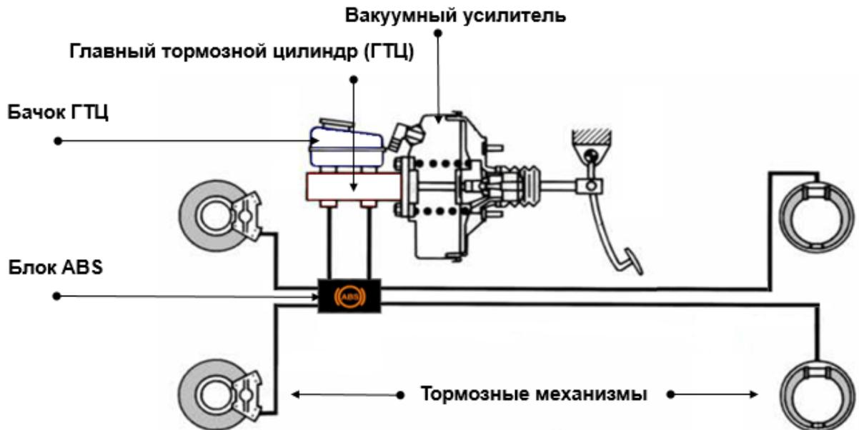
Рис. 2.5 – Схема тормозной системы автомобиля
