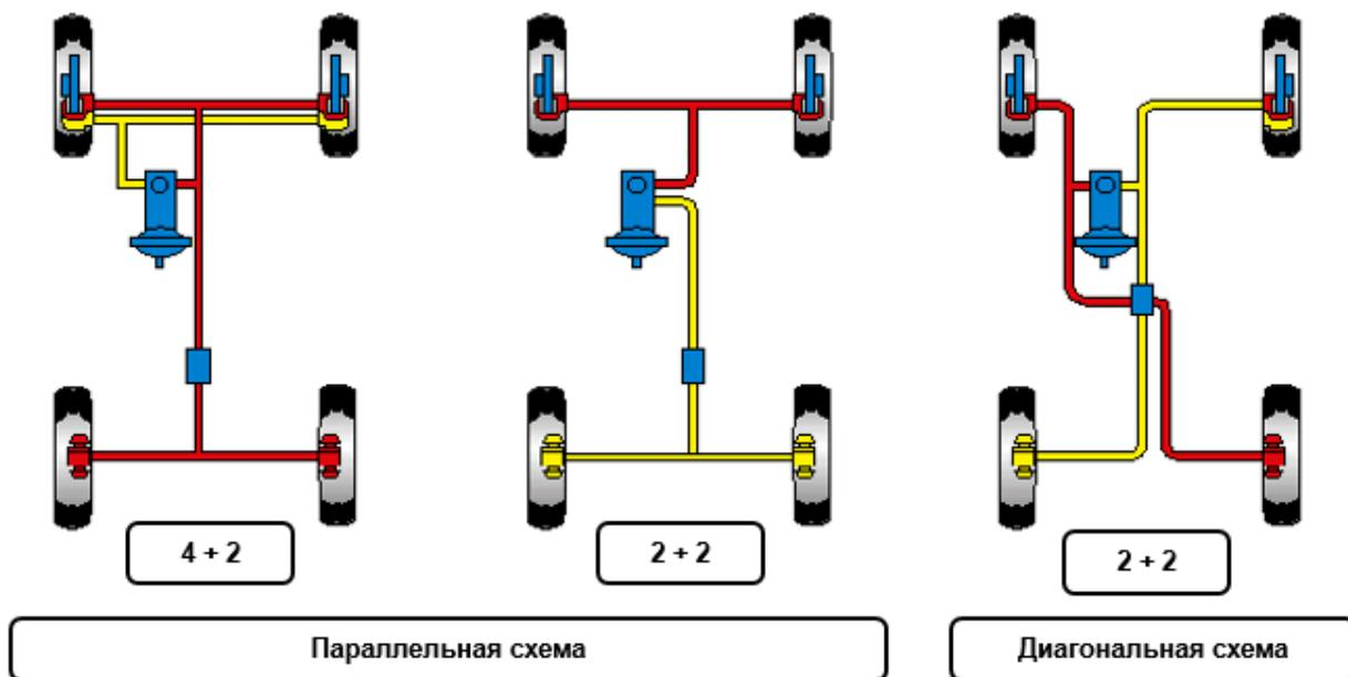
Рис. 2.6 – Виды контуров тормозной системы
