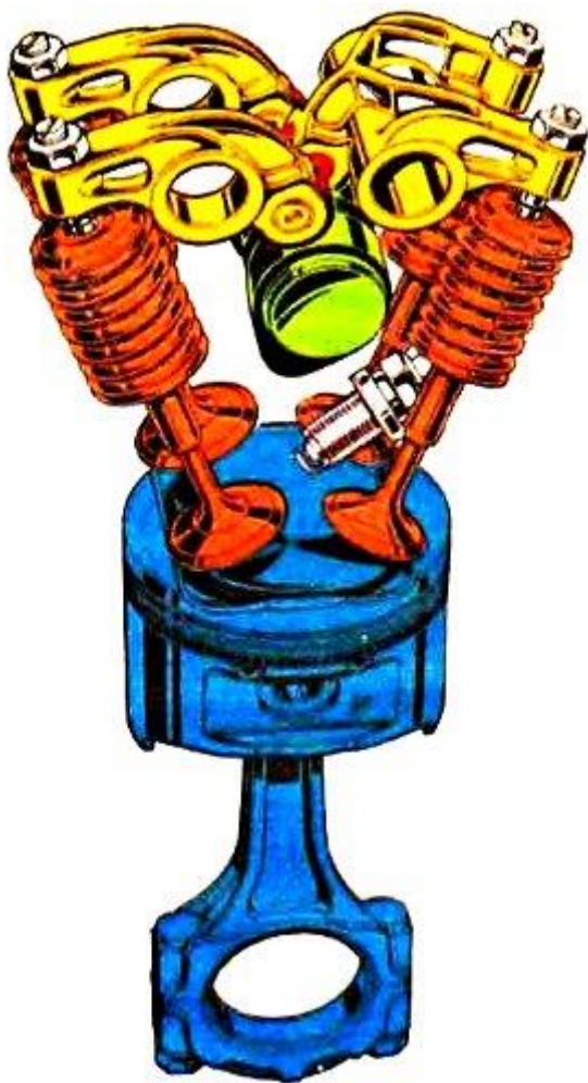
Рис. 2.15 – Уплотнения четырехклапанная конструкция для двигателей легковых автомобилей
