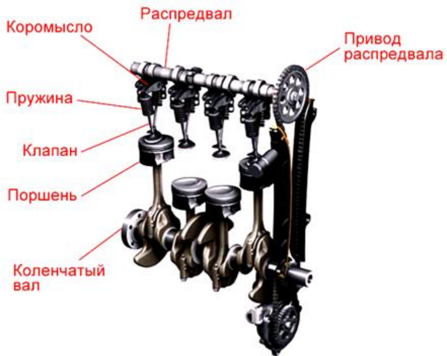
Рис. 2.4 – Схема привода ГРМ
