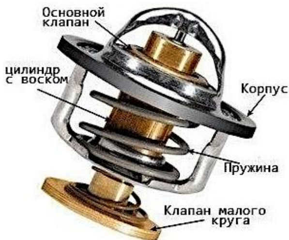
Рисунок 2.24 – Стандартный термостат системы охлаждения двигателя
