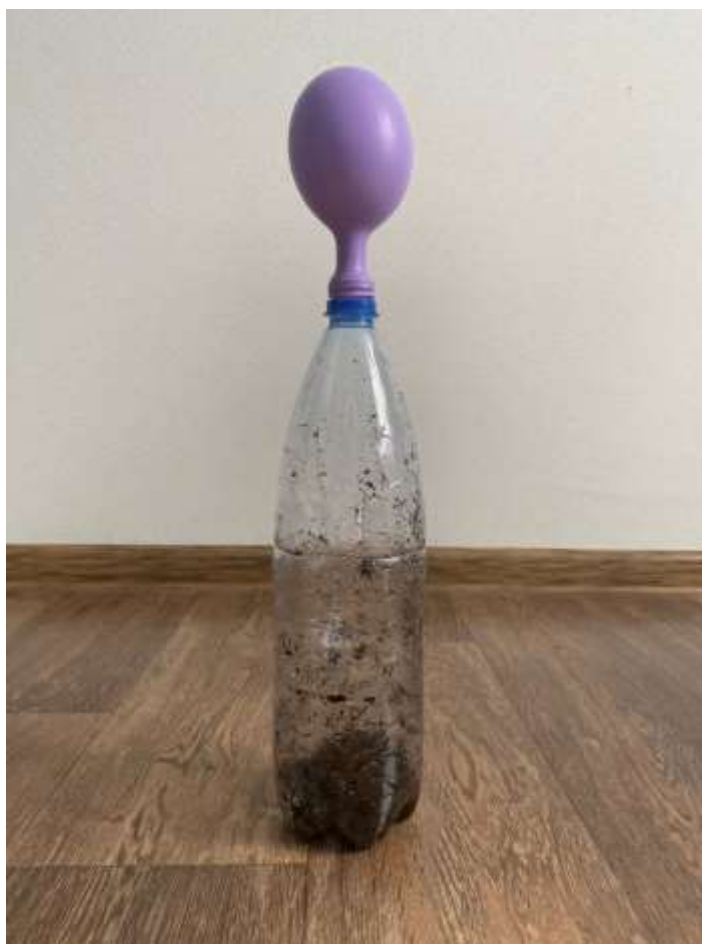
Рисунок 4.1 – Самодельный прибор для определения кислотности почвы
