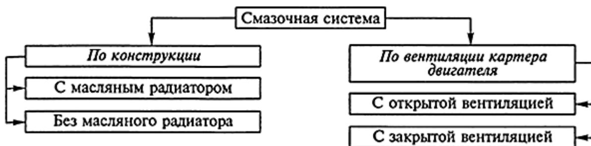
Рисунок 2.1 – Типы смазочных систем
