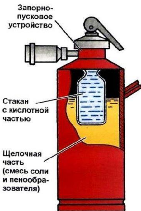
Рисунок 1 – Схема огнетушителя ОХП-10
