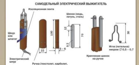
**САМОДЕЛЬНЫЙ ЭЛЕКТРИЧЕСКИЙ ВЫЖИГАТЕЛЬ**
