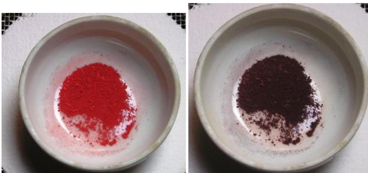
Рис. 27  $\text{Cu}_2\text{HgI}_4$ : Красный  $\rightleftharpoons$  Черный, при  $67,0^\circ\text{C}$
