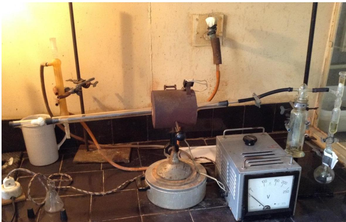
Рис. 28 Установка для получения безводного  $\text{CuCl}_2$
