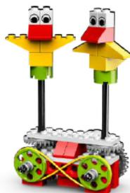
Учащиеся должны сконструировать двух механических птиц, которые способны издавать звуки и танцевать, и запрограммировать их поведение. В модели используется система ременных передач.
