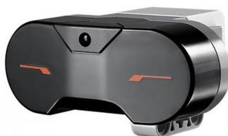
Рис. 12. Инфракрасный датчик
