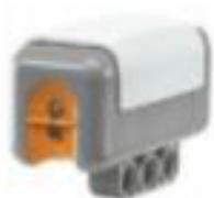
Рис. 2. Датчик освещенности
