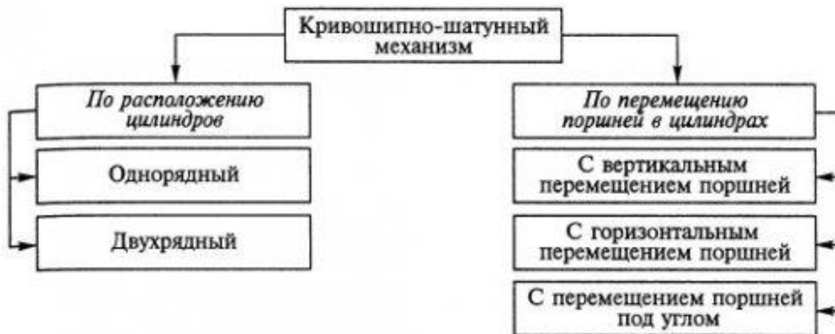
Рис. 2.2 – Типы кривошипно-шатунных механизмов, классифицированных по различным признакам
