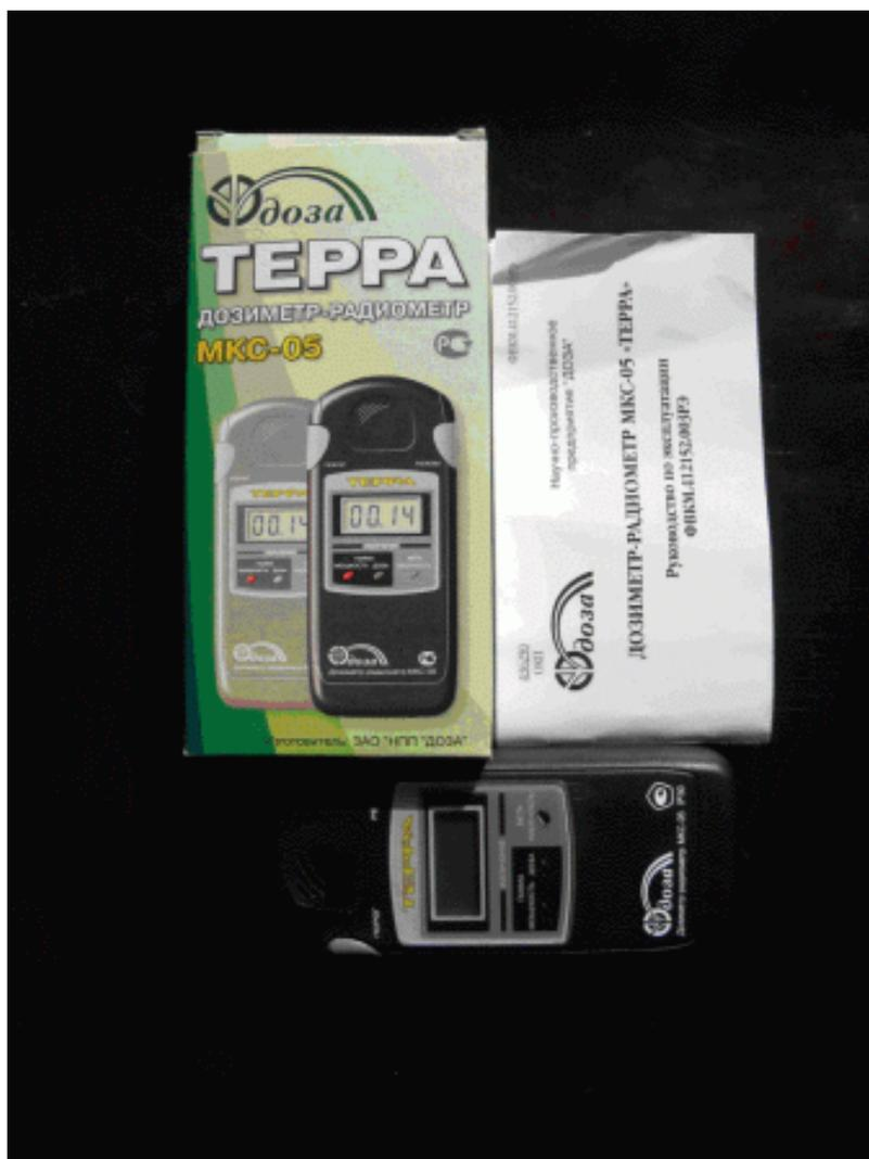
Рис.2. Дозиметр-радиометр ТЕРРА МКС-05
