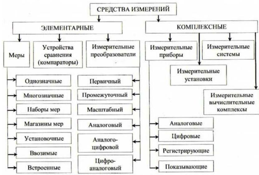
Рис. 1.3 – Классификация средств измерений по выполняемым функциям
