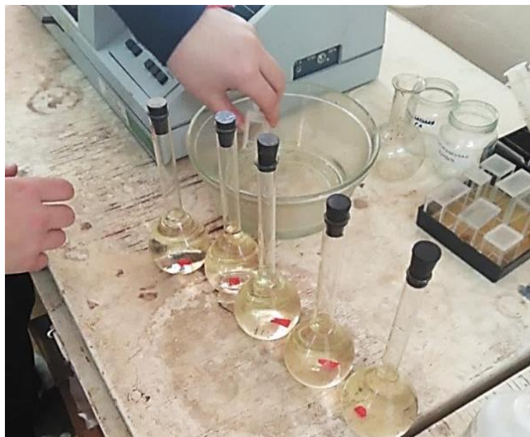
Рис. 7 Этап количественного определения дитерпеновых гликозидов методом фотоколориметрии
