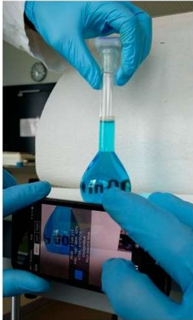
Рис. 21 Измерение раствора с помощью смартфона и приложения Color Grab
