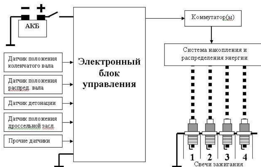
Рисунок 5 – Схема электронной системы зажигания
