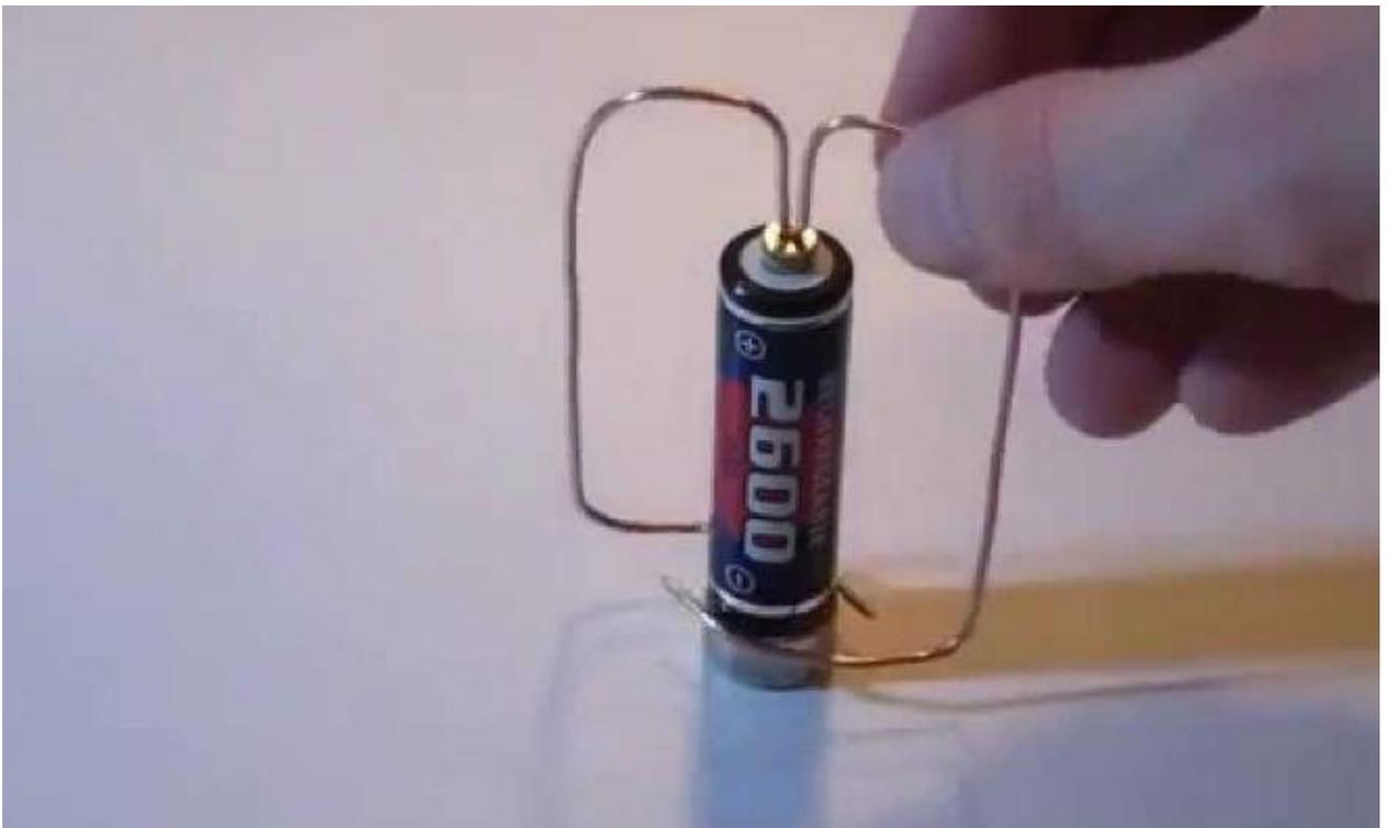
Рисунок D.8 – Вариант модели двигателя №2
