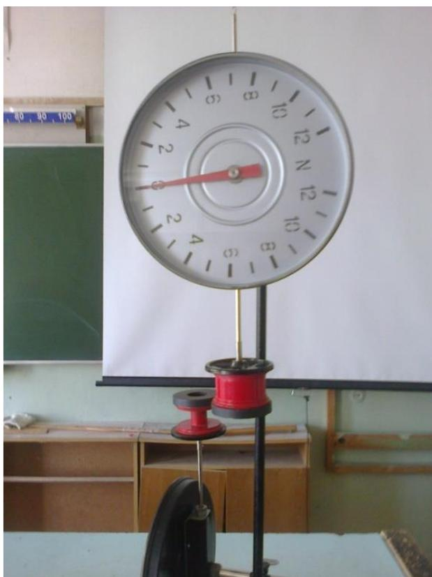
Рисунок 6 – Груз №1 вместе с магнитом (показания динамометра обнулены)
