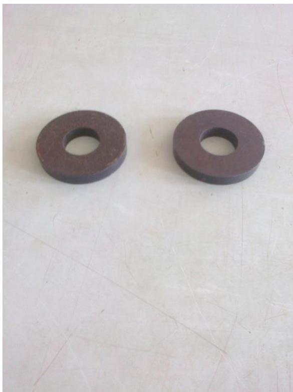
Рисунок 5 – Два одинаковых керамических магнита
