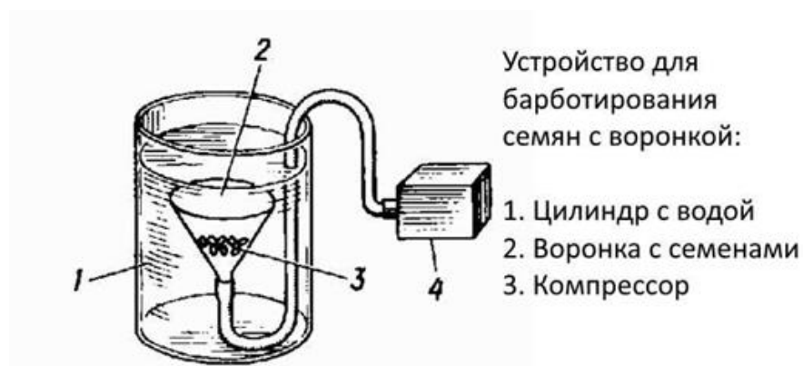
Рисунок 4 – Схема барботирования с воронкой [11]
