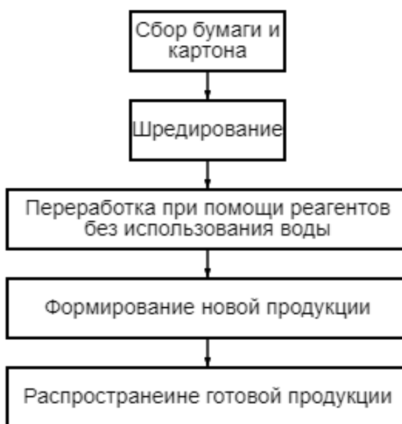
Рисунок 17 - Схема переработки бумаги и картона без использования воды
