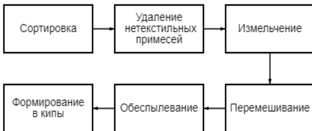
Рисунок 10 - Схема переработки текстильных отходов
