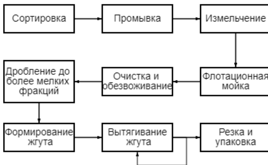
Рисунок 8 - Схема переработки ПЭТ-тары в ПЭТ-флейки
