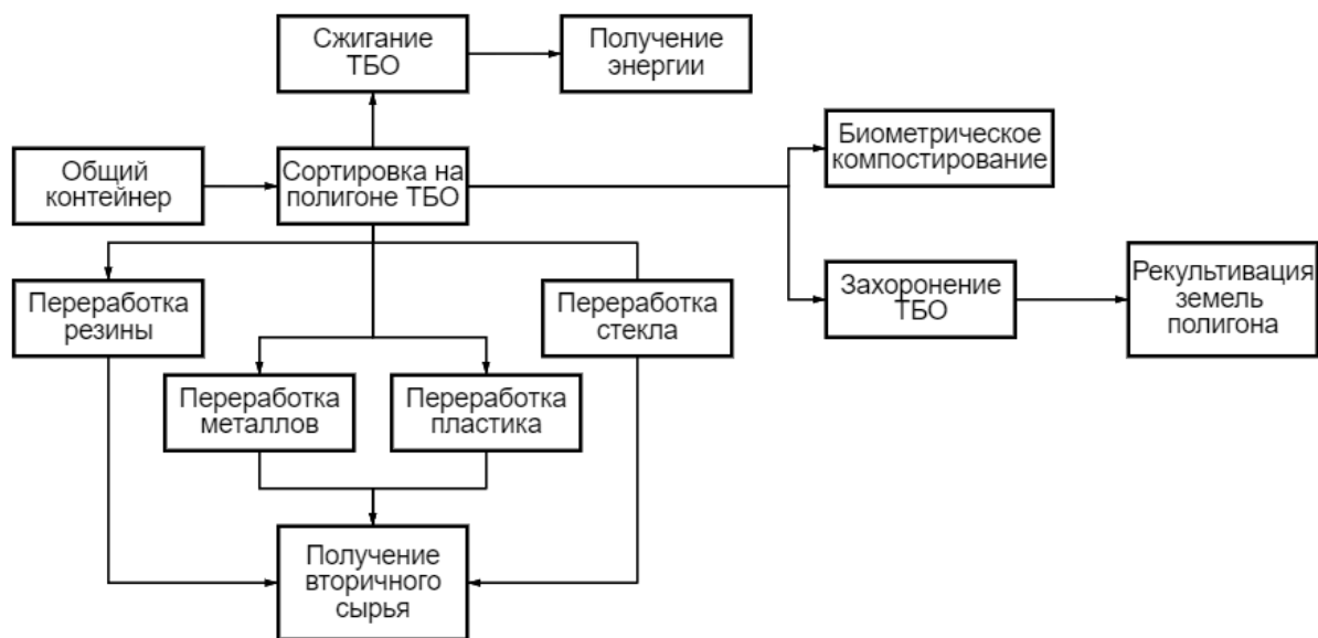
Рисунок 3 – Пути захоронения и переработки ТБО
