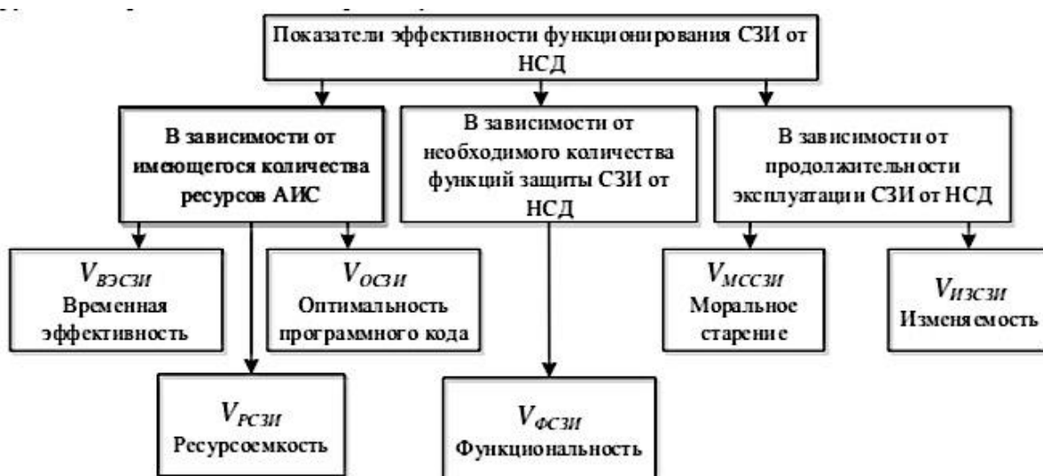
Рисунок 1.14 – Структурная схема показателей эффективности функционирования СЗИ от несанкционированного доступа в АИС
