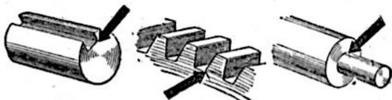
Рис. 7.28 – Влияние конфигурации детали на наличие концентраторов напряжений [87]
