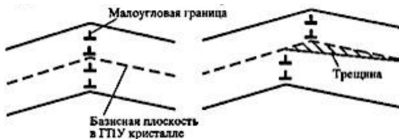
Рис. 7.23 – Возникновение трещины при перерезании малоугловой границы: а – до деформации; б – зарождение трещины
