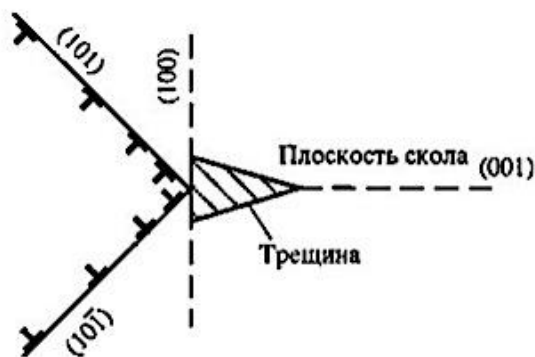
Рисунок 7.22 – Схема зарождения трещины в ОЦК-металлах
