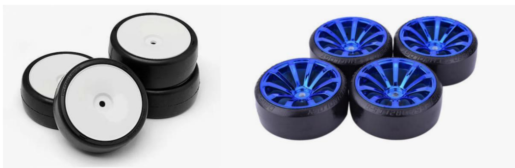
Рисунок 7 - Туринг колеса (слики) и дрифт колеса для автомоделей
