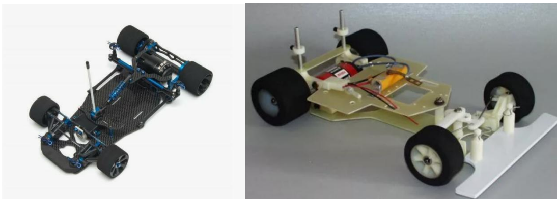
Рисунок 2 - Шасси автомоделей из карбона (слева) и из текстолита (справа)
