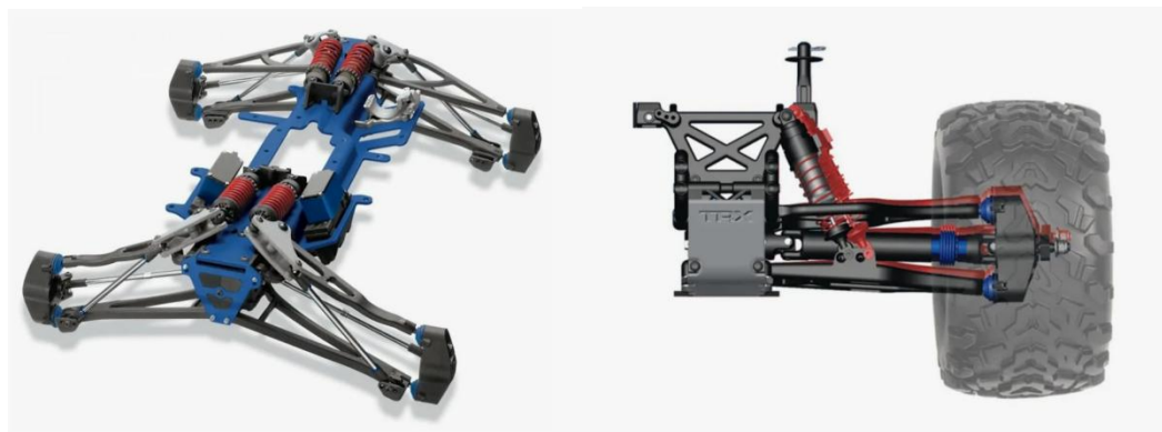
Рисунок 3 - Подвеска автомоделей (слева) и ее приближенная часть (справа)
