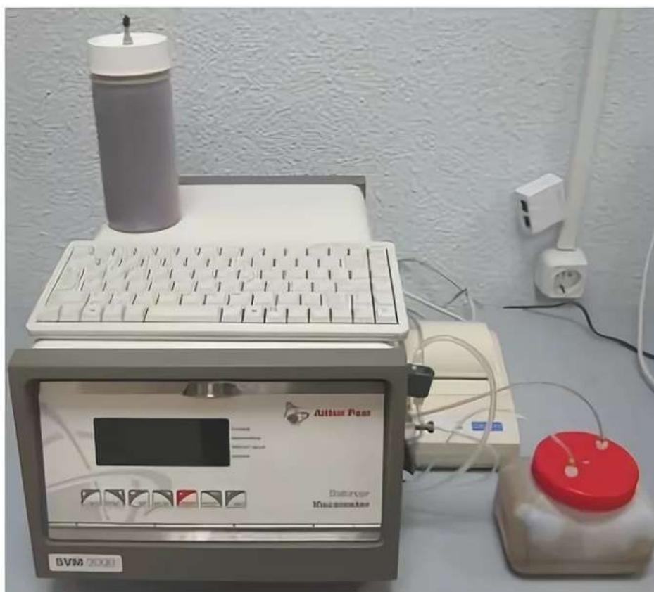
Рисунок 14 – Вискозиметр Штабингера SVM3000 Anton Paar
