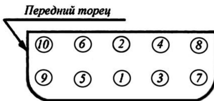
Рис. 2.3 - Порядок затяжки гаек головок– цилиндров двигателя
