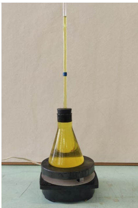
Рисунок 11 – Увеличение объема жидкости при нагревании
