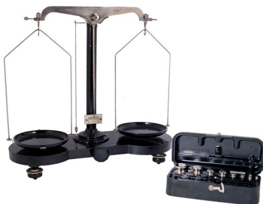
Рисунок 13. Весы технические демонстрационные
