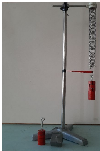
Рисунок 25 – Растяжение пружины под действием одного груза
