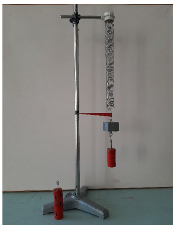
Рисунок 24 – Растяжение пружины под действием веса двух грузов
