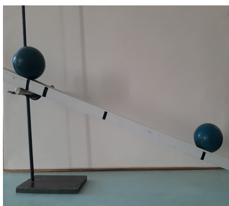
Рисунок 19 – Установка для демонстрации неравномерного движения
