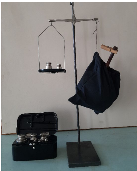
Рисунок 39 – Взвешивание шара после откачивания воздуха
