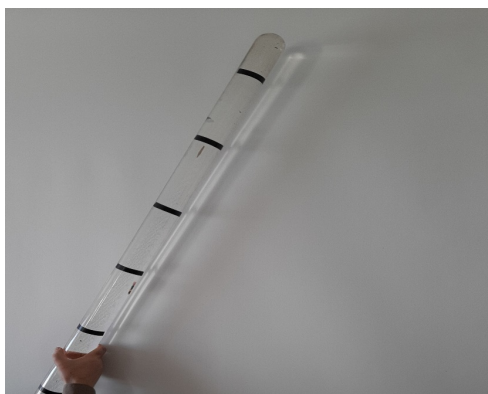
Рисунок 18 – Установка для демонстрации равномерного движения тела
