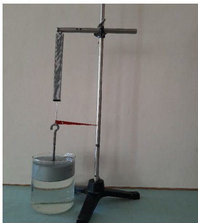
Рисунок 33 – Действие выталкивающей силы на тело, находящееся в жидкости
