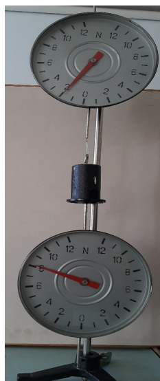
Рисунок 26 – Нижний динамометр показывает значение равнодействующей двух сил, направленных в противоположные стороны
