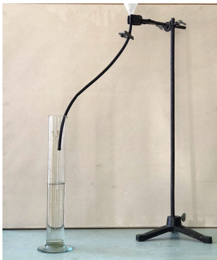
Рисунок 5 – Оборудование для проведения опыта диффузии жидкостей
