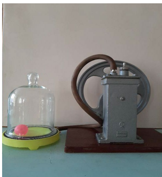
Рисунок 38 – Откачивание воздуха из колокола
