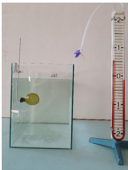
Рисунок 32 – Измерение давление внутри жидкости
