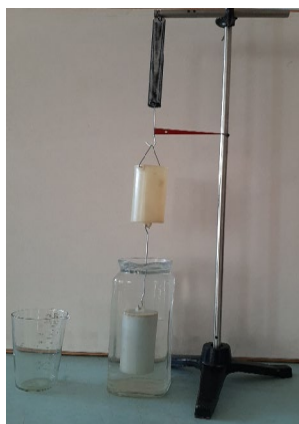
Рисунок 36 – После переливания воды из оставленного стакана пружина занимает первоначальное положение
