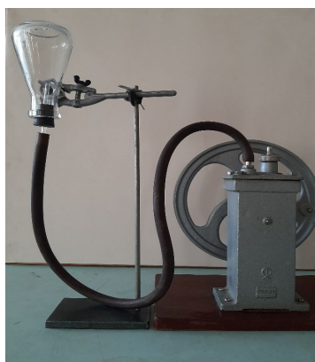
Рисунок 37 – Установка для демонстрации опыта «Фонтан в разряженном воздухе»
