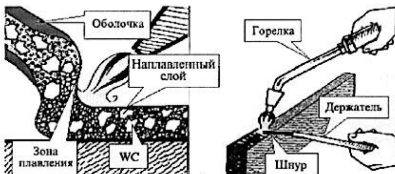
Рис. 3.30 – Технология ручной газопламенной наплавки шнурового материала «Сфекорд-НР» [100]
