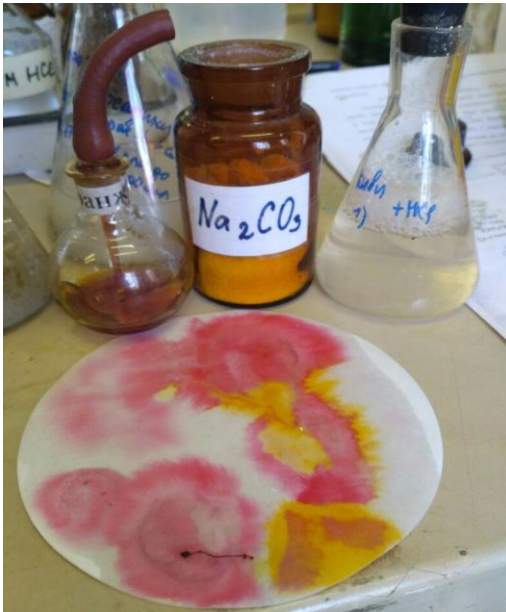
Рис. 10 Нейтрализация испытуемого раствора \text{Na}_2\text{CO}_3 по индикатору метиловому оранжевому
