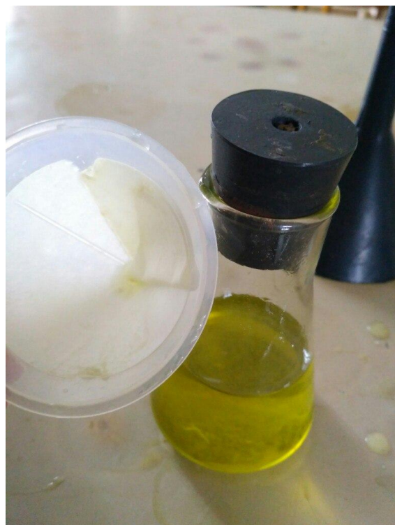
Рис.25 Растворение осадка оксида меди (I) в растворе \text{Fe}_2(\text{SO}_4)_3
