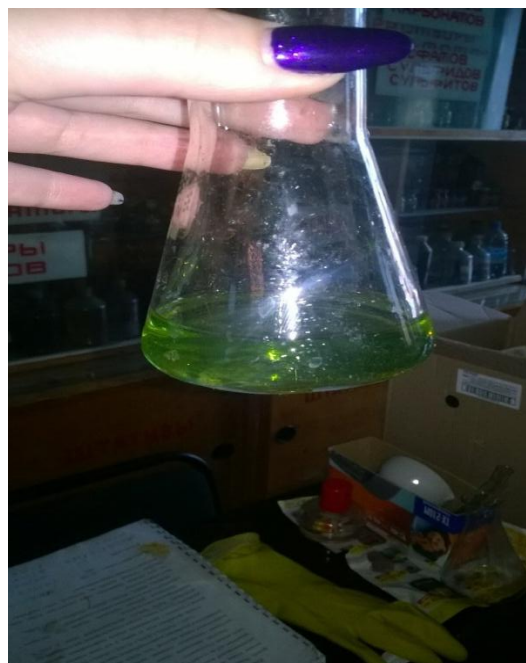
Рис.15 Растворение осадка оксида меди (I) в растворе \text{Fe}_2(\text{SO}_4)_3
