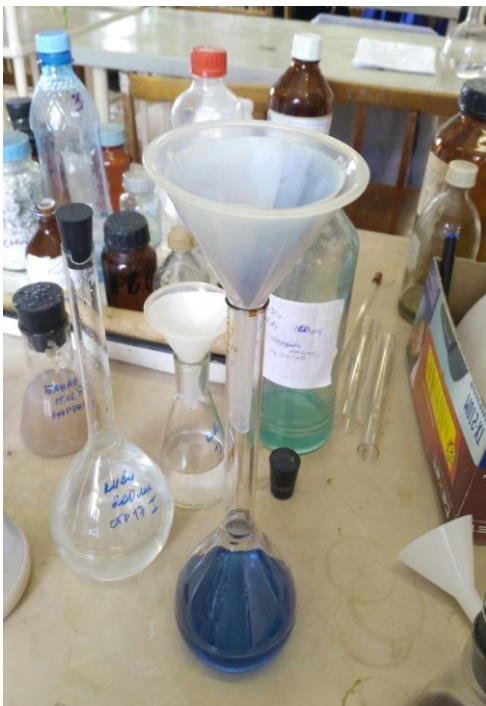
Рис. 12 Отделение осадка оксида меди (I) методом фильтрации
