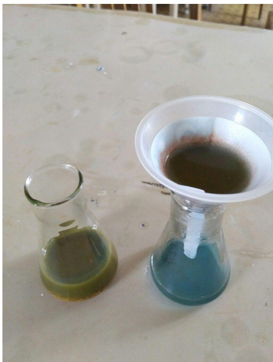
Рис. 24 Отделение осадка оксида меди (I) методом фильтрации .
