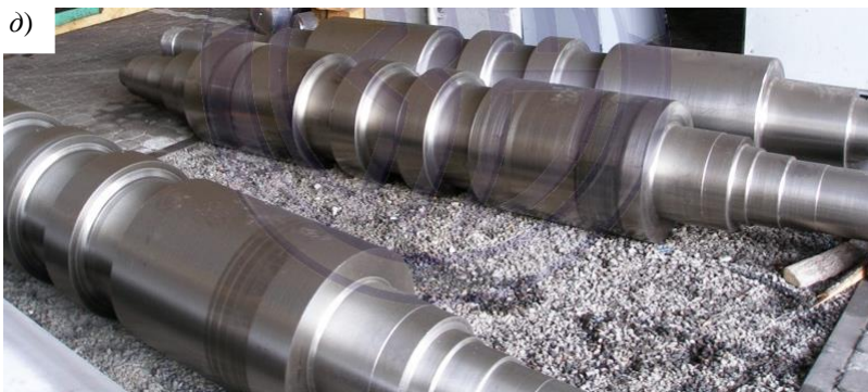
Рис. 1.6. Прокатные валки ( a – с гладкой поверхностью и б – калиброванный или ручьевого валок), типы калибров ( в – открытого типа и г – закрытого типа) и общий вид калиброванных (ручьевых) валков ( д ): 1 – хвостовик; 2 – шейка; 3 – бочка (гладкая); 4 – вырезы (ручьи); 5 – калибры
