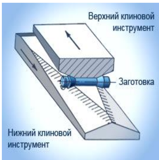
Рис. 2.17. Схема ПКП заготовки с использованием двух плоских плит
