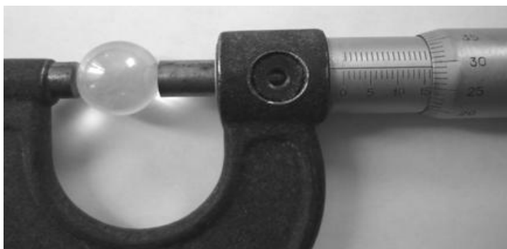
Рис. 7. Измерение диаметра шарика микрометром
