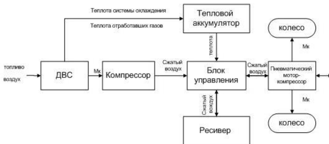
Рис. 17. Пневматическая ГЭУ с тепловым аккумулятором
