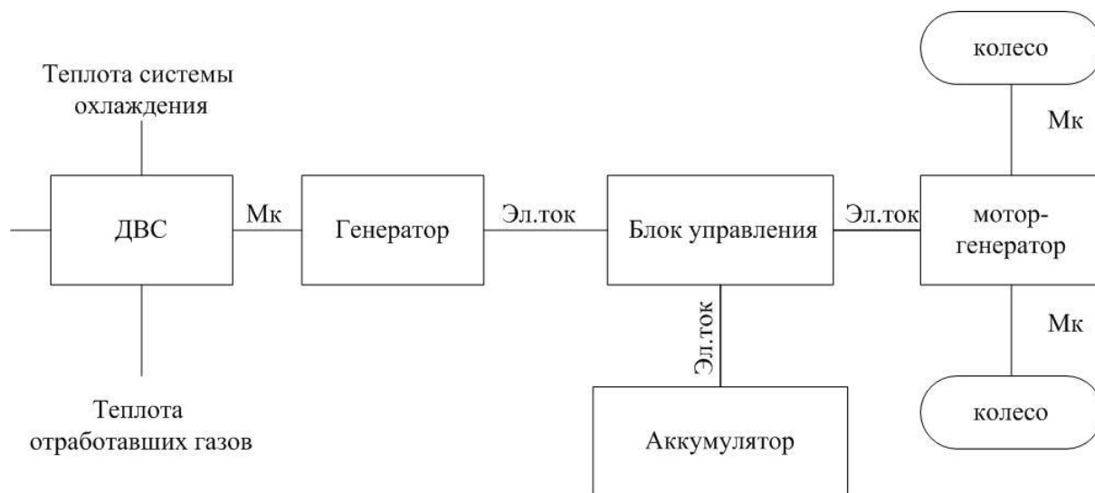
Рис.2. Электрическая гибридная силовая установка
