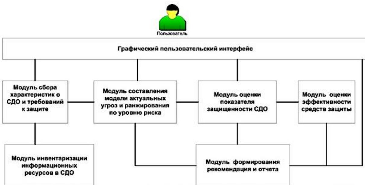
Рисунок 3.3.2 – Архитектура программного прототипа оценки защищенности СДО
