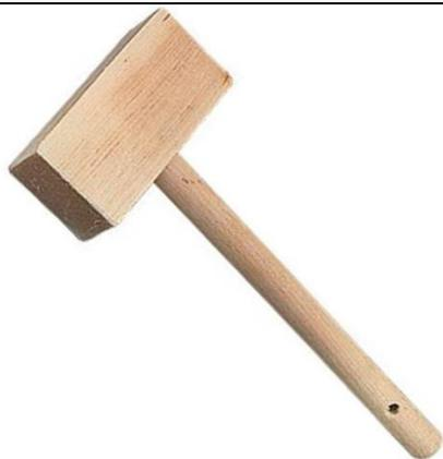
Кия́нка — столярный молоток из дерева твёрдых пород. Есть виды работ, в которых нужен более мягкий подход и не требуется большой силы. Распрямление пластин из металла, работа с долотами и стамесками, рукоятки которых имеют обжимное кольцо, сборка мебели — в таких видах работ и пригодится киянка. Пользование киянкой предохраняет рукоятки режущих инструментов от повреждений.
