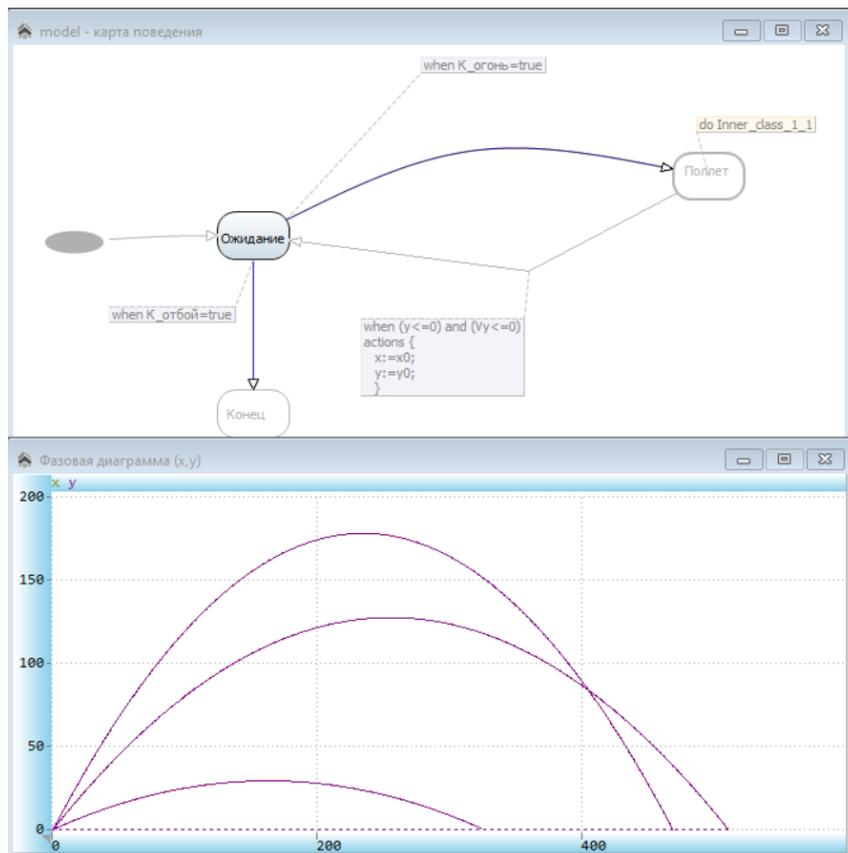
Рис. 3.5.5. Результат моделирования (траектории при разных значениях  $\text{Alpha}0$ )
