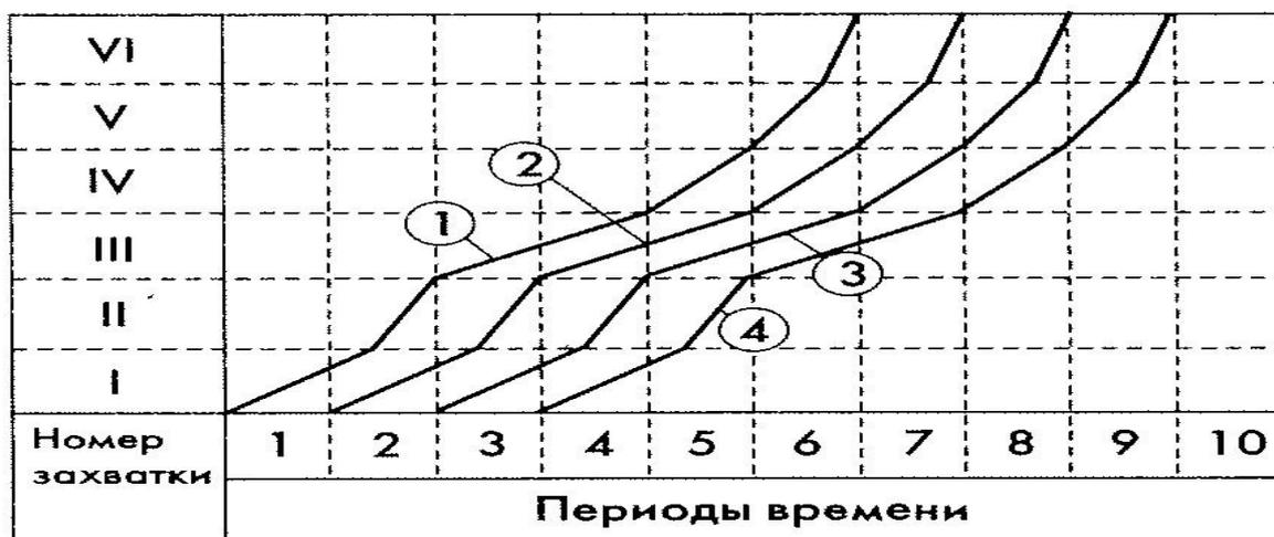
Рисунок 6 - Циклограмма неритмичного потока
