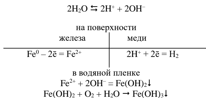
Рисунок 28 – Схема электрохимической водородной коррозии железа
