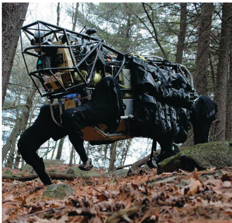
Рисунок 1. Робот Big Dog, разработанный компанией Boston Dynamics 15 , использует двигатель внутреннего сгорания
