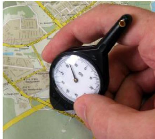
Рис. 2. Измерение расстояний по карте с помощью курвиметра
