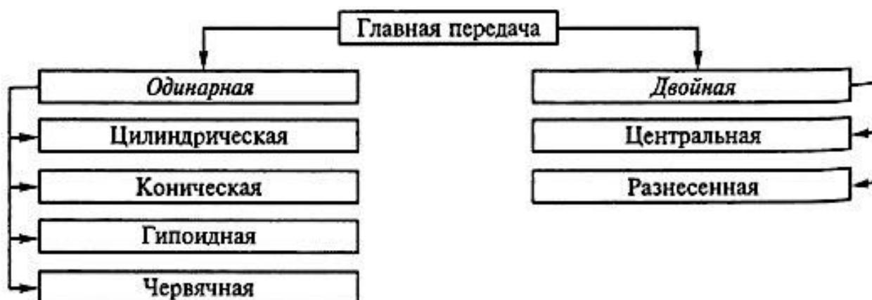
Рис. 2.3 – Типы главных передач
