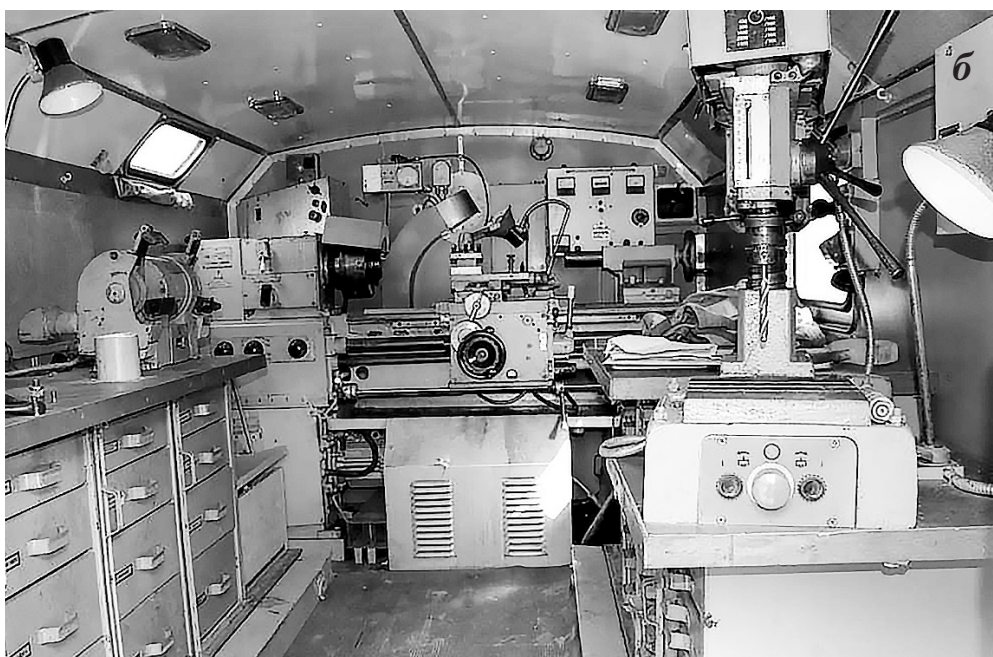
Рис. 33 (а и б). Внутренняя часть кузова передвижных мобильных автомастерских
