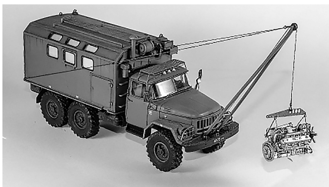
Рис. 27. Общий вид спереди подвижной автомастерской со стрелой
