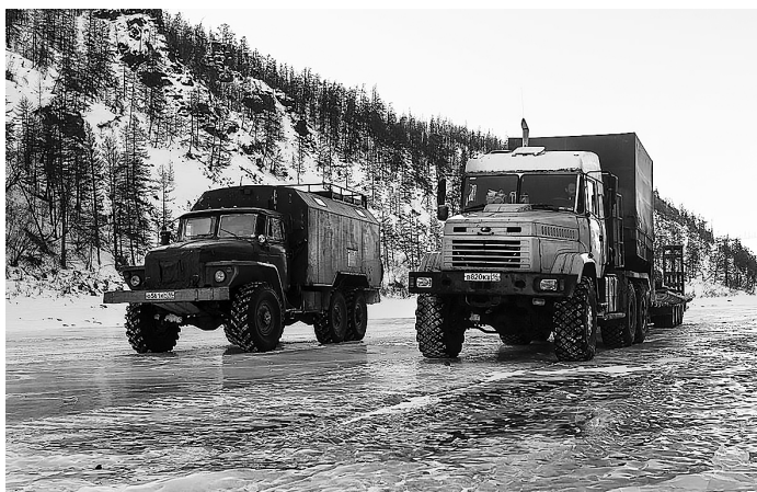
Рис. 5. Автотранспорт семейств «КРАЗ», «Урал», оборудованных утеплителем, для севера России
