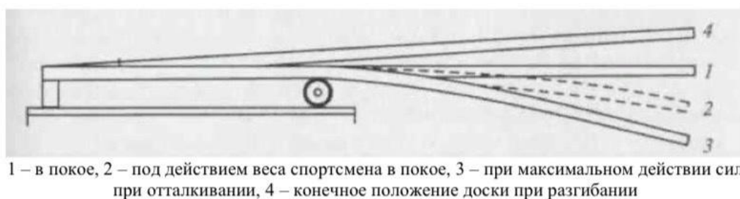
Рисунок 2 – Изменение положения доски трамплина при отталкивании
