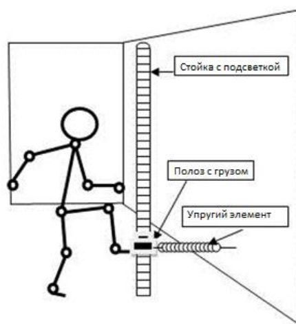
Рисунок 7 – Тренировочное устройство для определения точности воспроизведения заданных силовых и пространственных параметров движения при воздействии внешних сил разной модальности и направления вектора действия
