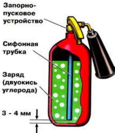
Рис. 3. Углекислотный огнетушитель
