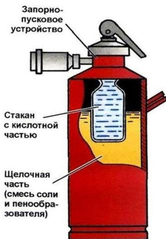
Рис. 1. Схема огнетушителя ОХП-10
