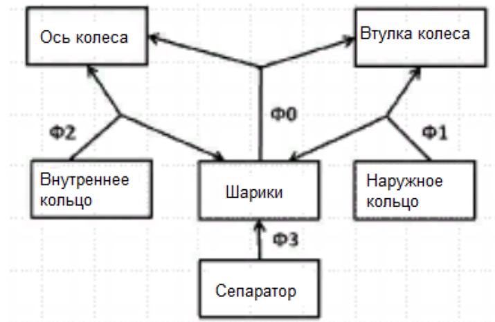
Рис. 11. Функциональная схема подшипника [33]
